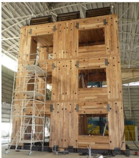
CLT建築の耐震実験
